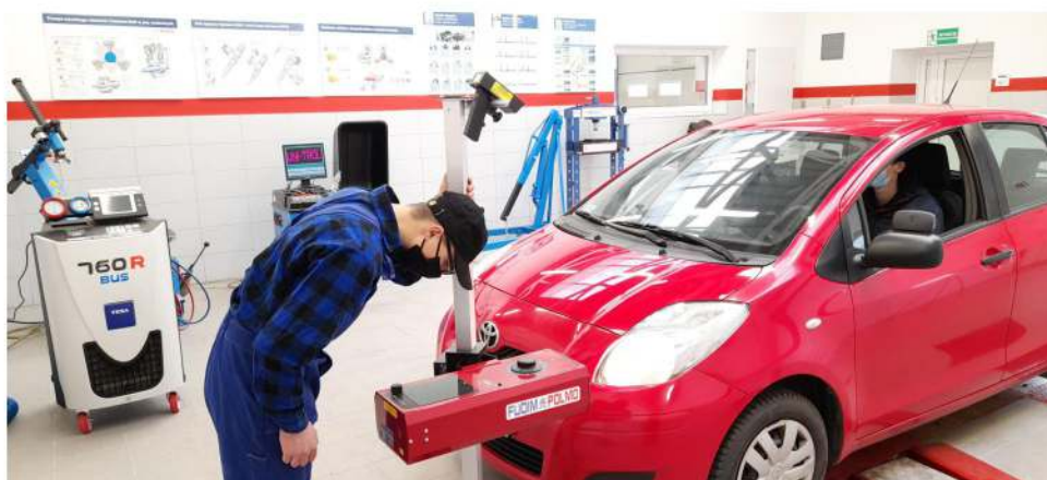
Uczeń sprawdza oświetlenie pojazdu w szkolnej pracowni diagnostyki samochodowej
